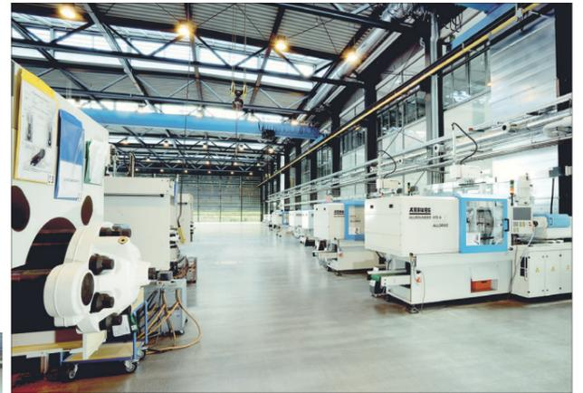
Von Tageslicht durchflutete Produktionshalle mit Spritzgussmaschinen.
