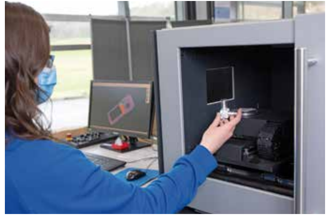
Der Computertomograph checkt Lagetoleranzen sowie Verzug und analysiert das Innenleben auf Lunker.
