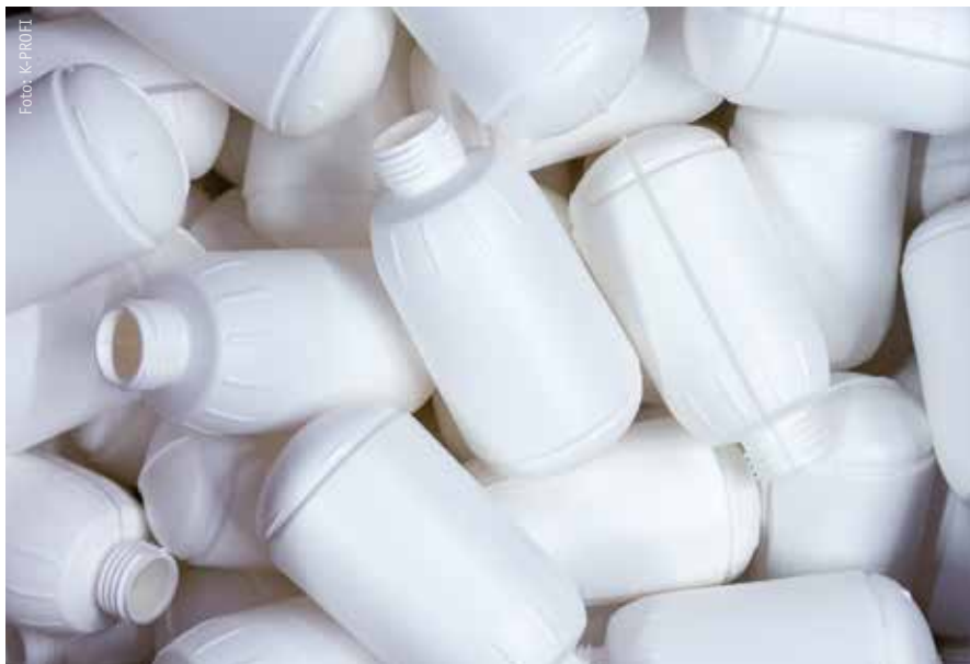
Die Behälter der Druckpumpzerstäuber sind extra dickwandig (im Mittel 4 mm). Sie halten dem geforderten Betriebsdruck von 3 bzw. 4 bar stand.
