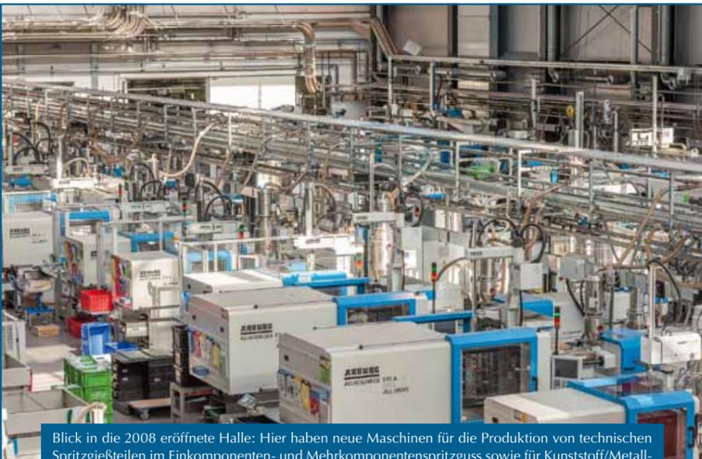
Blick in die 2008 eröffnete Halle: Hier haben neue Maschinen für die Produktion von technischen Spritzgießteilen im Einkomponenten- und Mehrkomponentenspritzguss sowie für Kunststoff-/Metallverbindungen ihren Platz gefunden.
